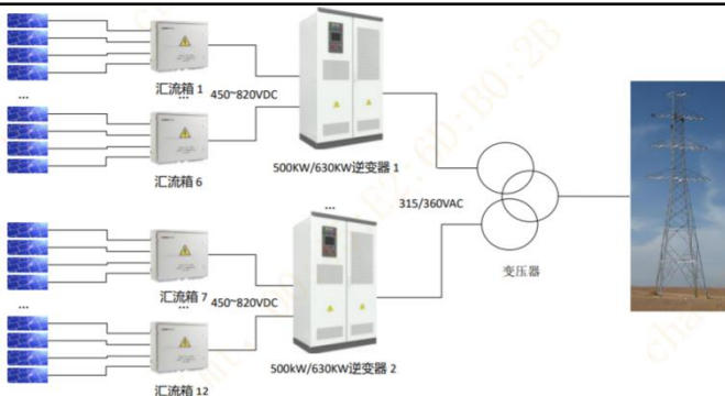
图表 7. 集中式逆变器先汇流再逆变
