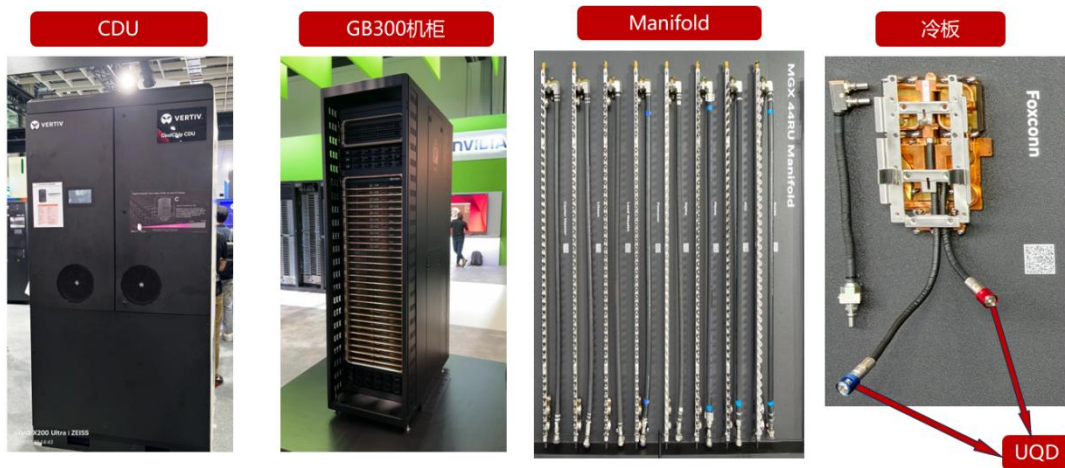
图11: GB300 NVL72 液冷方案: 机房内实物拆解
