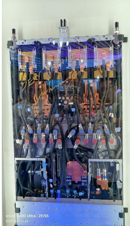
图9: GB300 NVL72 compute Tray 示意图
