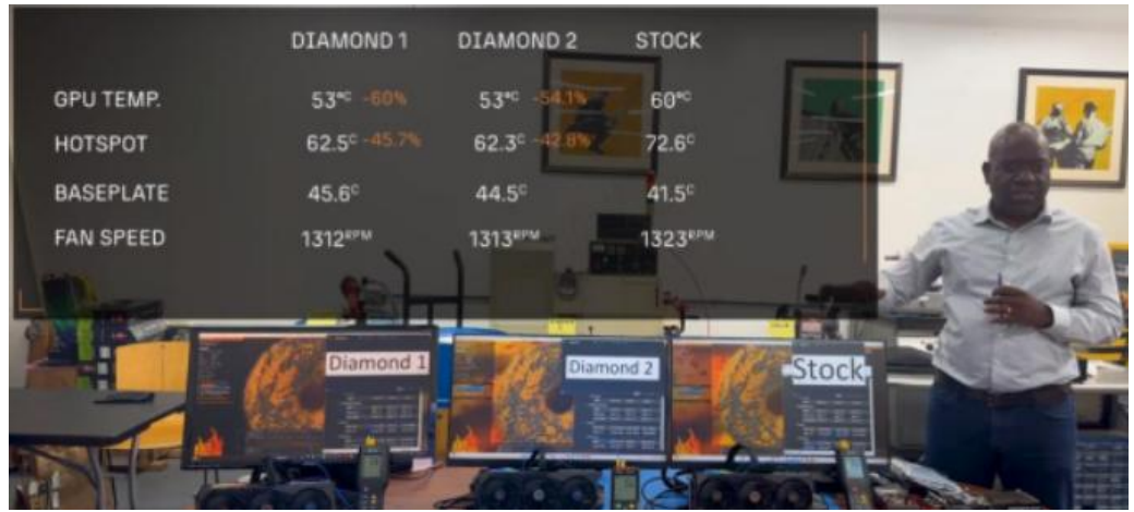
图表 9: 金刚石 GPU 与非金刚石 GPU 参数对比
